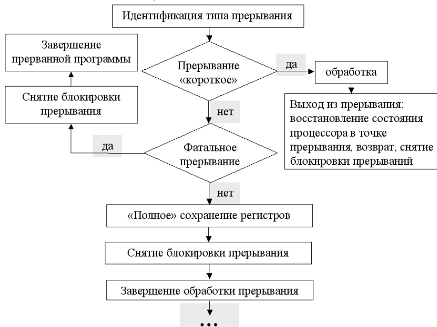
Рис. 33. Программный этап обработки прерываний.
