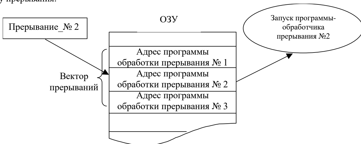
Рис. 31. Модель организации прерываний с использованием «вектора прерываний».
