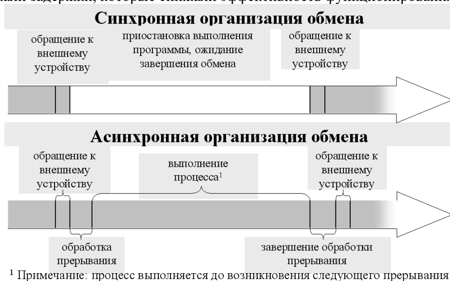
Рис. 39. Синхронная и асинхронная работа с ВУ.
