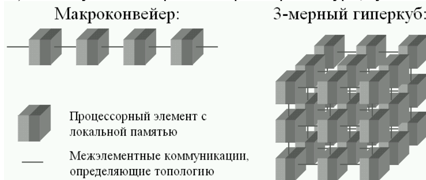
Рис. 62. Примеры топологий MPP-систем.
